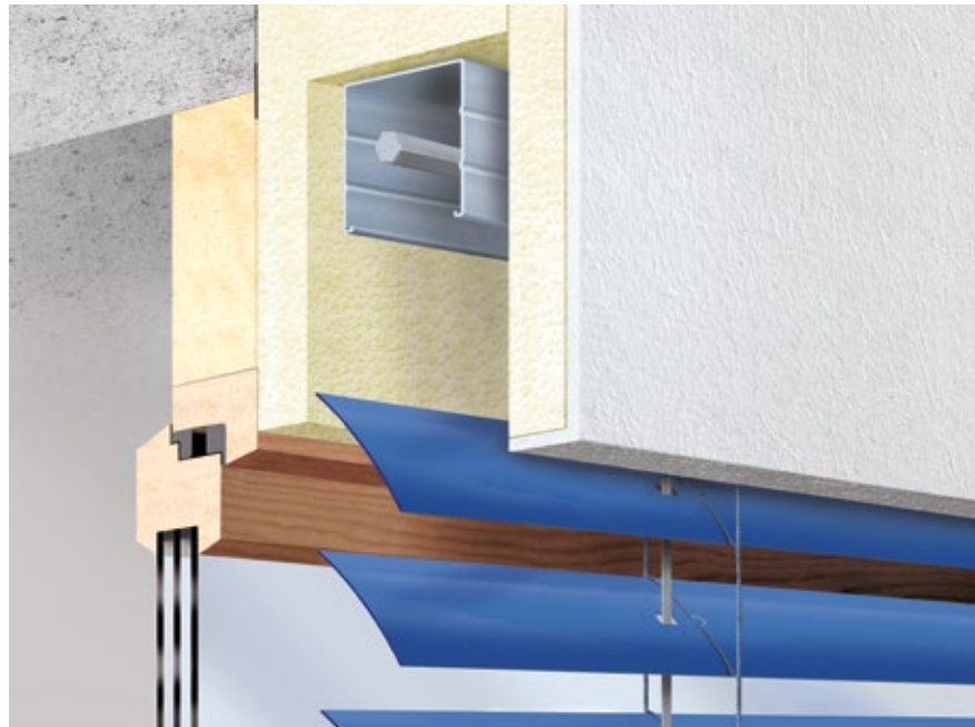
Coupe horizontale pour commande par treuil
