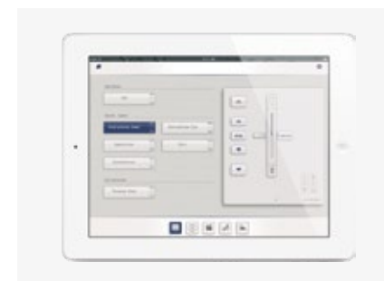
Commande KNX / gBUS par iPad
